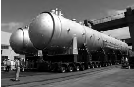
森松工業(株)：ニッケル鉱産向けチタンク ラッド製オートクレーブ
