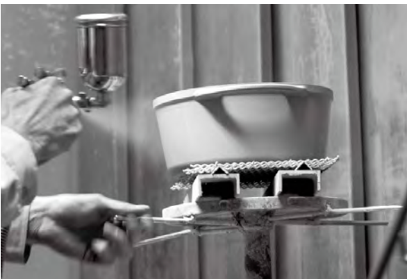
ホーローの吹き付け・焼成の工程
