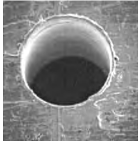
(株)ダイニチ：顕微鏡で見たΦ0.02mmの穴
