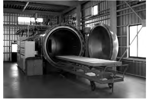
東明工業(株)：CFRPを硬化成形するオートクレーブ
