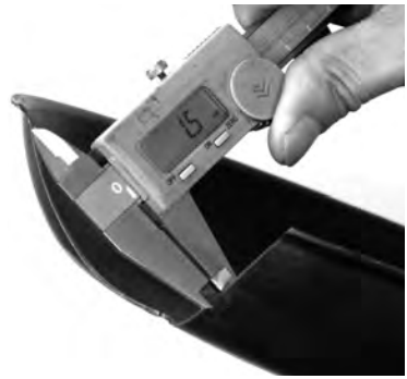
錦見铸造(株)：板厚1.5mmの魔法のフライパン
