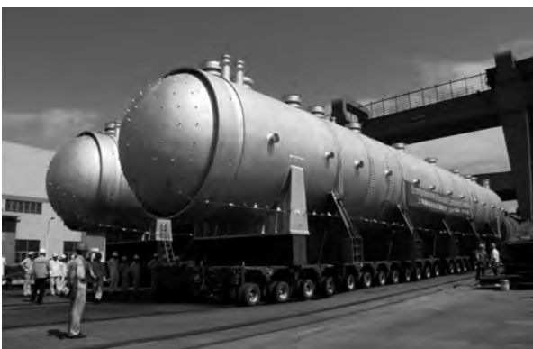
ニッケル鉱産向けタンクラッド製オートクレーブ (納入先：マダガスカル、パプアニューギニア)
