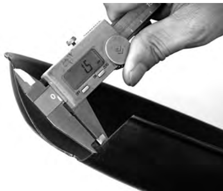
熱しやすく冷めにくい板厚1.5mmのダクタイル鋳鉄
